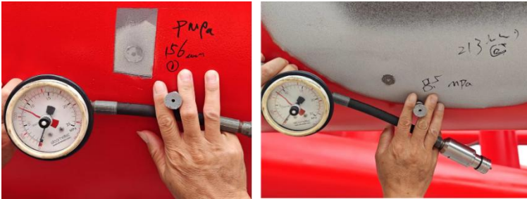
图 13 拉开法检验涂层附着力
